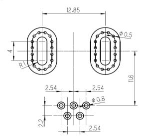
注)被測定電流ラインとして2層以上のパターンを使用する場合は、 層間に十分に電流が流せるようにスルーホール設置を推奨します。
