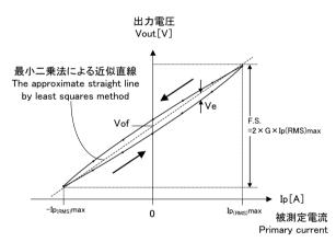
・ $\mathbf{Ip}_{(RMS)}$ maxが測定電流範囲Ifよりも大きい場合には、 $\mathbf{Ip}_{(RMS)}$ maxはIfの電流値とする。
