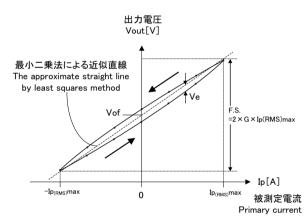
·感度G[mV/A], 中点電圧Vof[V]
