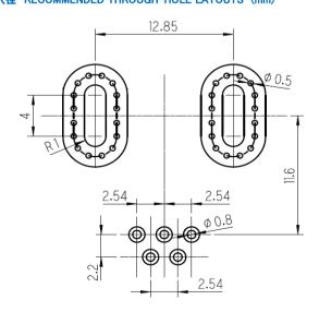
注)被測定電流ラインとして2層以上のパターンを使用する場合は、 層間に十分に電流が流せるようにスルーホール設置を推奨します。
