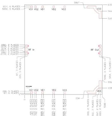
Overall die size 5300 x 6100 (+0/-50) microns, die thickness 100 (+/-10) microns.
